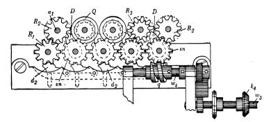
FIG. 47.—(<sup>2</sup>/<sub>3</sub> actual size.) Quotient mechanism.
